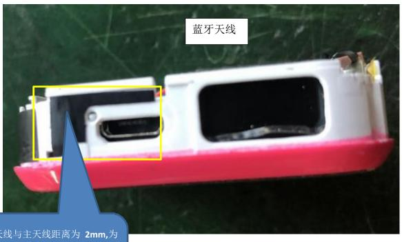
蓝牙天线与主天线距离为 2mm,为了防止两天线之间的隔离度问题,所以将蓝牙设计为单极形式,主要影响蓝牙的是 USB,走线方面也已经尽量避开。将影响降到最低。
