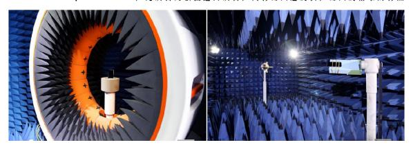
ETS 543 暗室, 此暗室为美国进口设备, 完全的远场测试, 配合调试测试 2D 数据, 测试速度快, 与 satimo 暗室 3D 测试完美结合。
