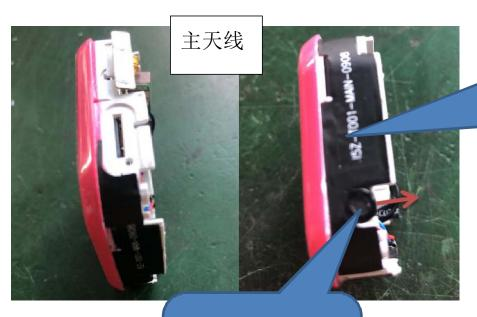
由于手表主要以穿戴来衡 量天线性能的指标,再设计 之初就已经考虑到,所以主 天线如右图,全部利用到侧 面来降低人手的衰减。天线 面积预留很充分。当然天线 支架延伸到屏幕面, 更能降 低人手的衰减,但由于整机 ID 的限制,不能实现。
