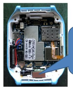
儿童智能手表当然少不了 GPS 定位功能。GPS 就是通过接受卫星信号,进行定位或者导航的终端,而接受信号就必须用到天线。考虑到天线的位置,GPS 陶瓷采用的是较为常用的正方形,合理的利用了整机有限的内部空间。
